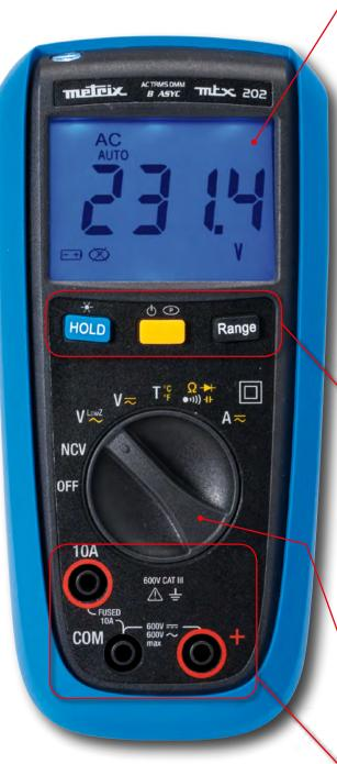
Afficheur numérique monochrome (52 x 37 mm) avec rétroéclairage bleu.
